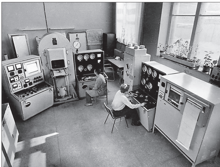
За работой в прессовом зале. Установки УВД-2000 (до 200 кбар) и поршень-цилиндр (до 40 кбар)
