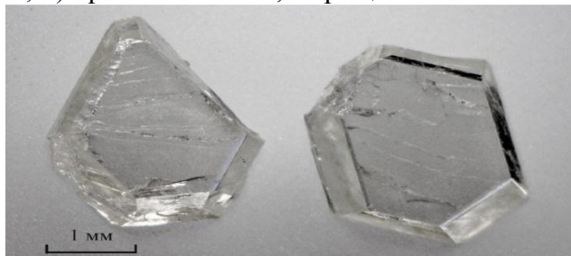
Рис. 10. а) Кристалл алмаза, выращенный в системе Fe-Ni-C, (Ti 7 мас.%), опыт № 5-27-03; б) кристалл алмаза, выращенный в системе Fe-Ni-C, (Ti 4.9 мас.%), опыт № 4-18-03.
