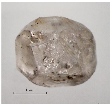
Рис. 10. а) Кристалл алмаза, выращенный в системе Fe-Ni-C, (Ti 7 мас.%), опыт № 5-27-03; б) кристалл алмаза, выращенный в системе Fe-Ni-C, (Ti 4.9 мас.%), опыт № 4-18-03.
