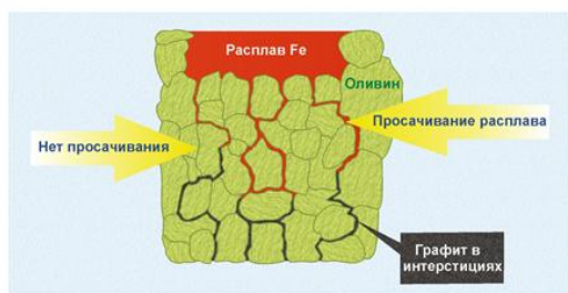
Схематическое изображение механизма просачивания расплава железа сквозь оливиновую матрицу перекристаллизации углерода
