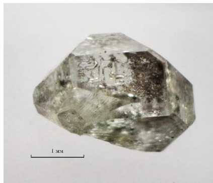
Рис. 10. а) Кристалл алмаза, выращенный в системе Fe-Ni-C, (Ti 7 мас.%), опыт № 5-27-03; б) кристалл алмаза, выращенный в системе Fe-Ni-C, (Ti 4.9 мас.%), опыт № 4-18-03.
