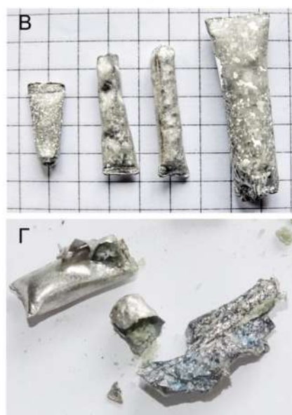
Рисунок 1.8. Экспериментальные платиновые ампулы. (А) Одиночная ампула, загруженная кристаллами оливина и водным флюидом. (Б) Двойная ампула с внешним буфером в междуампульном пространстве. (В) Платиновые ампулы после опыта, мозаичная текстура платины объясняется перекристаллизацией в присутствии потока водорода. (Г) вскрытые после опыта ампулы с оливином.
