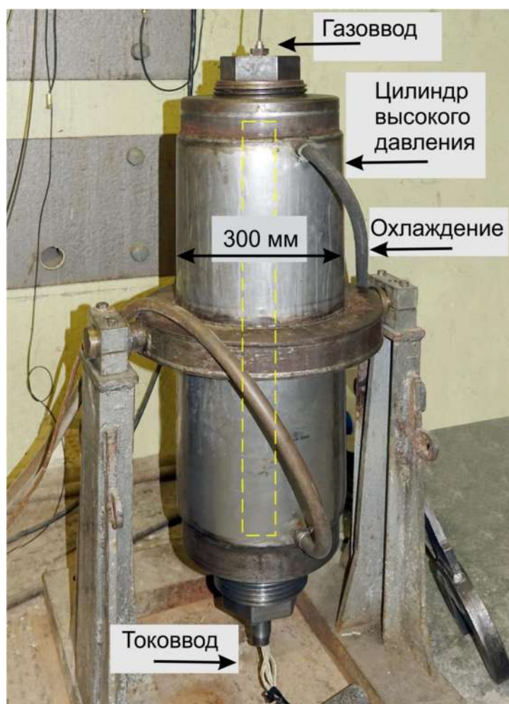
Рисунок 1.9. Установка высокого давления с внутренним нагревом (УВД), ИЭМ РАН. Установка представляет собой стальной цилиндр с осевым каналом. Трубчатая электропечь с теплоизоляцией из \text{Al}_2\text{O}_3 и длиной рабочей (изотермической) зоны 50 мм помещается внутрь канала. Контроль температуры осуществляется при помощи двух термопар Pt10%Rh–Pt. С одной стороны цилиндра расположен токоввод, по которому в рабочую зону подается ток для нагревателя и снимаются показания термопар. С другой стороны расположен газоввод, в который по капилляру подается среда, передающая давление (аргон). Пунктиром показан внутренний канал диаметром 50 мм. Установка предназначена для работы с давлениями до 0,6 ГПа.
