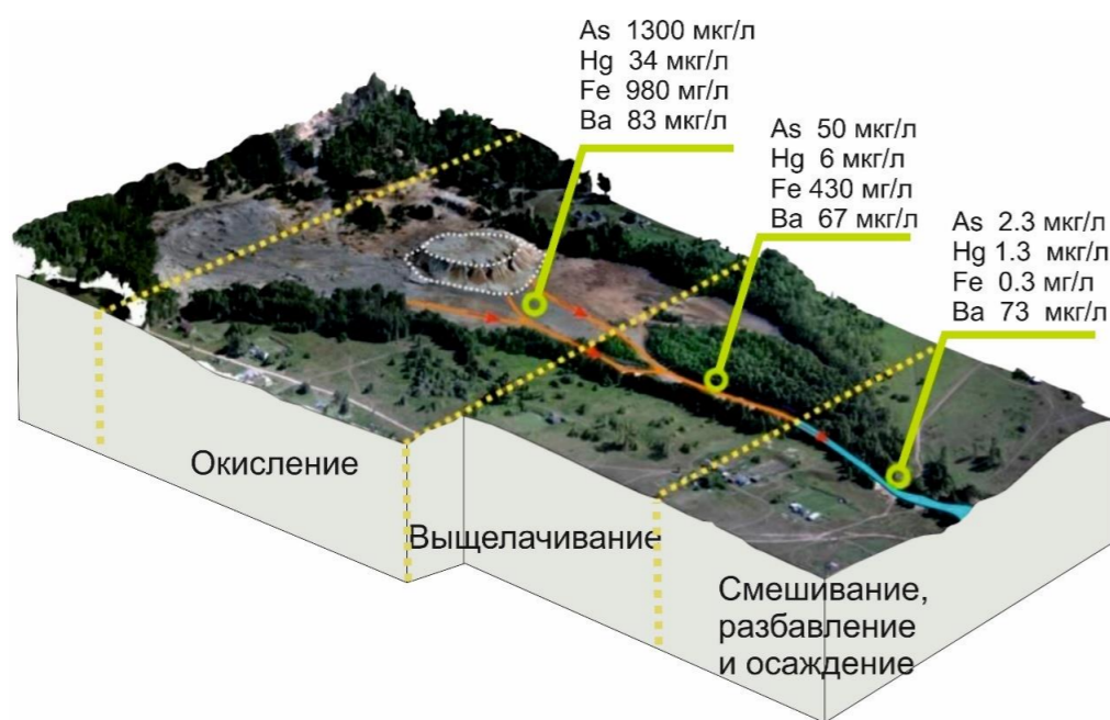
Рисунок 8 – Принципиальная схема строения Урской дренажной системы: распределение зон окисления, выщелачивания и смешения
