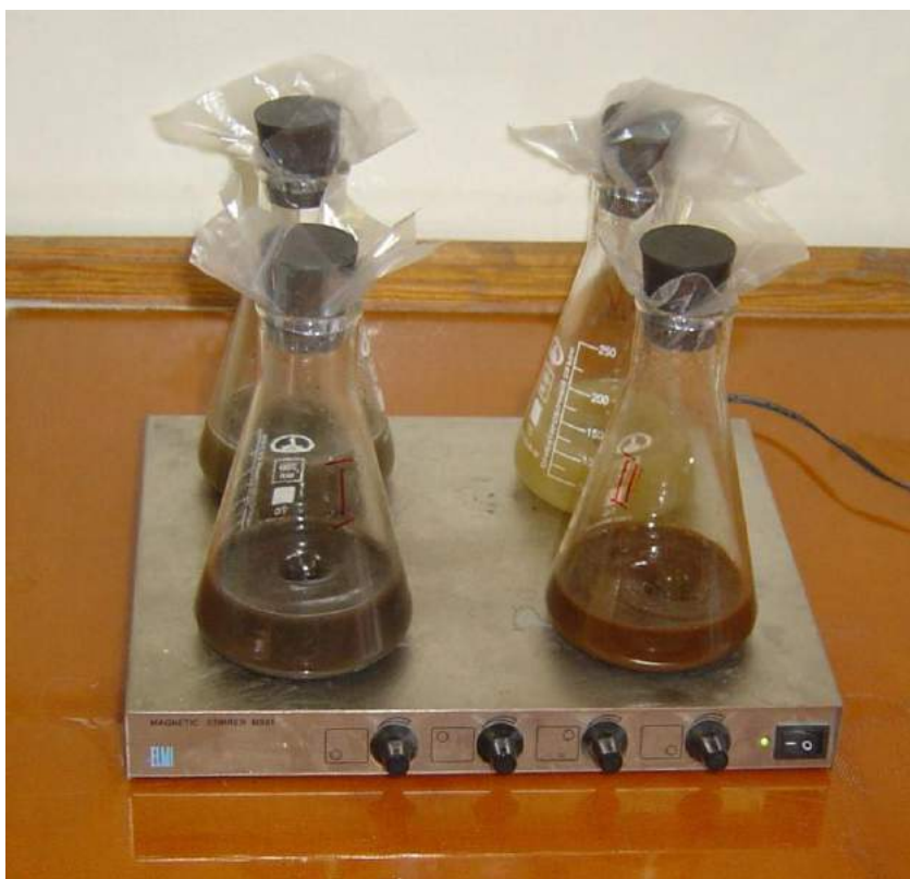
Рис.3.2. Проведение статического эксперимента в лаборатории. Процесс перемешивания растворов на магнитных мешалках (фото Богуславского А.Е.)
