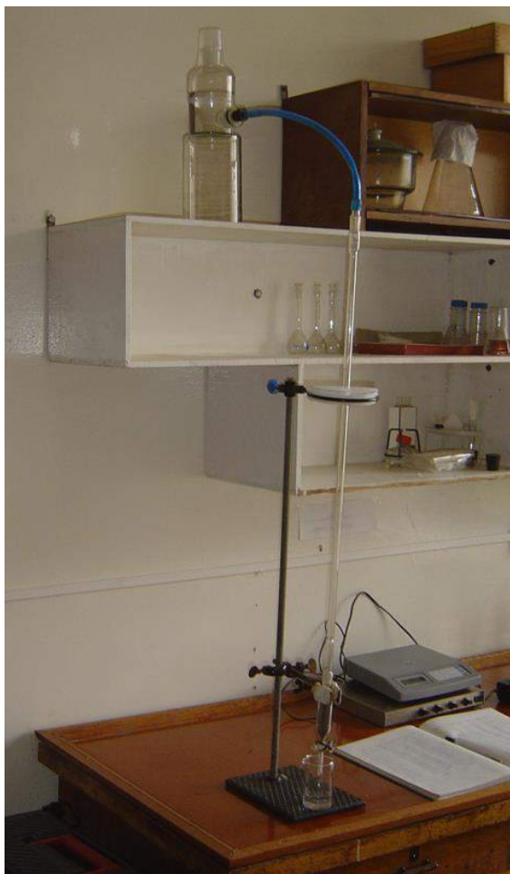
Рис. 3.1. Проведение динамического эксперимента в лаборатории. Внизу находится емкость с грунтом, через который проливается экспериментальный раствор (фото Богуславского А.Е.)
