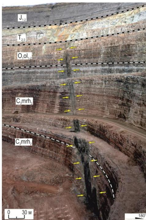
Рисунок 15. Выход дайки долерита по Широтному разлому в юго-восточном борту карьера «Нюрбинский» (фото автора).
