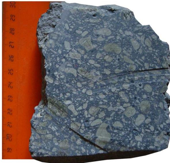
Рисунок 47. Крупный обломок порфирового кимберлита в АКБ центральной части трубки «Ботуобинская», скв. 60/560, гор. +120 [Кошкарев, 2015ф].
