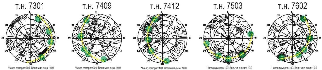
Рисунок 34. Круговые диаграммы, на которых зафиксированы пояса трещиноватости. Желтой пунктирной линией обозначен пояс трещиноватости, зелеными кругами – максимумы, его образующие. Проекция верхней полусферы, изолинии проведены с шагом 1 %.
