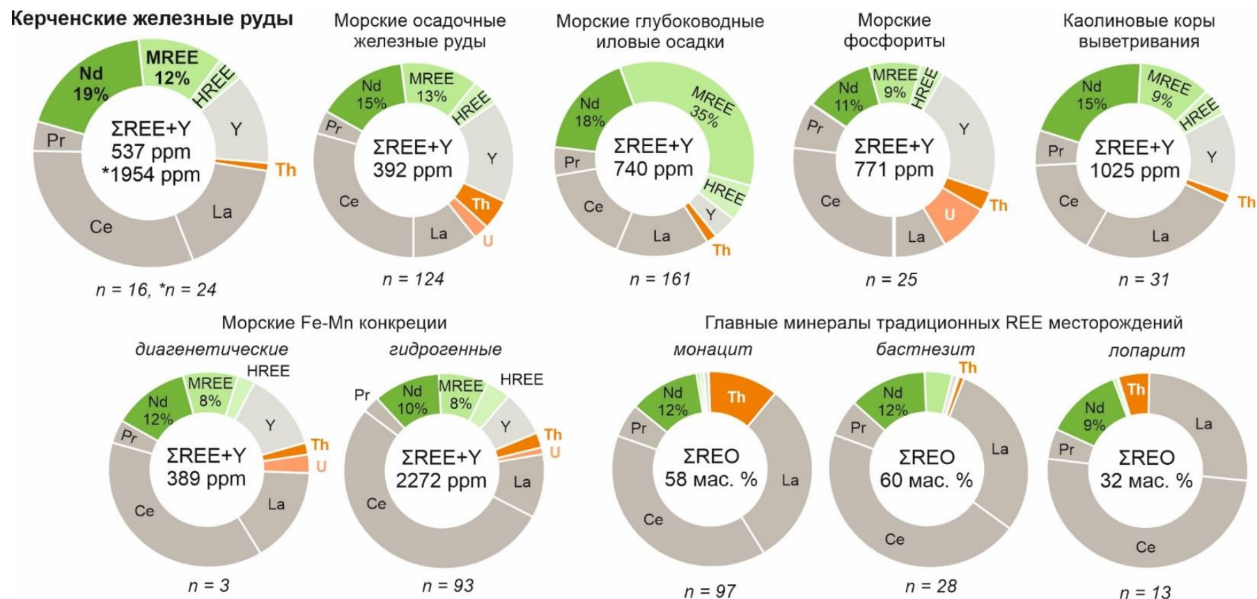
Рис. 15. Средние относительные содержания REE, Y, Th и U в керченских железных рудах в сравнении с таковыми других типов нетрадиционных и традиционных REE руд. Концентрации REE и Y: морские оолитовые руды [Afify et al., 2018; Baioumy et al., 2017; Garnit, Bouhlef, 2017; Rahiminejad, Zand-Moghadam, 2018; Rudmin et al., 2019]; морские иловые осадки [Kato et al., 2011]; морские фосфориты [Emsbo et al., 2015]; морские диагенетические Fe-Mn конкреции [Батулин, 2009]; морские гидрогенные Fe-Mn конкреции [Chen et al., 2018; Conrad et al., 2017; Hein et al., 2016; Muñoz et al., 2013]; каолиновые коры выветривания по гранитам (ионно-адсорбционные глины) [Bao, Zhao, 2008]; монацит из карбонатов, гранитов, сиенитов и россыпей [Лазарева и др., 2015; Andreoli et al., 2014; Berger et al., 2008; Deng et al., 2017; Grammatikopoulos et al., 2013; Kravchenko, Pokrovsky, 1995; Lapin et al., 2016; Le Bas et al., 1992; Lottermoser et al., 1990; Singh, 2020]; бастнезит из карбонатов, гидротермально измененных нефелиновых сиенитов [Xu et al., 2008; Grammatikopoulos et al., 2013; Jaireth et al., 2014; Andersen et al., 2017]; лопарит из нефелиновых сиенитов [Kogarko et al., 2002]. *Средние содержания ΣREE+Y в тонких фракциях керченских железных руд.
