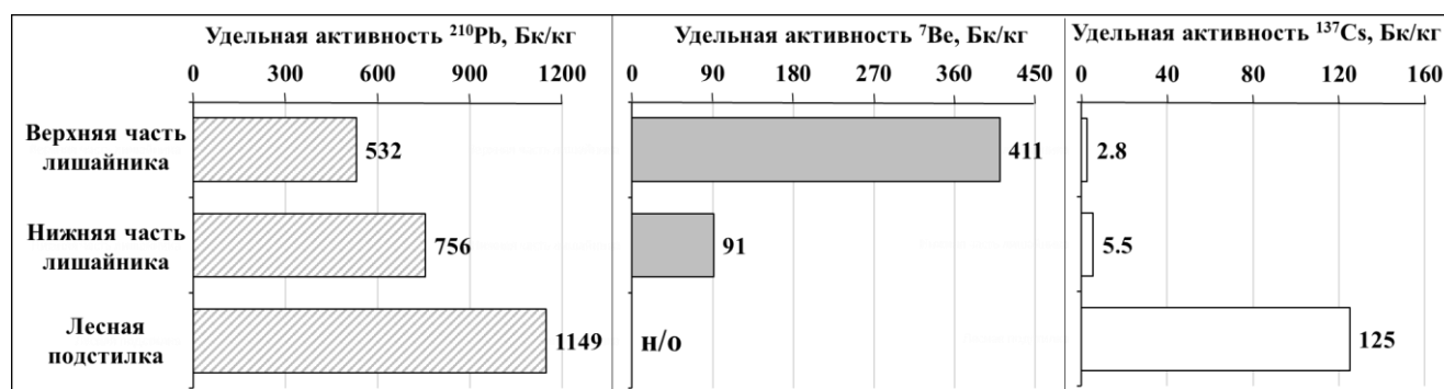
Рисунок 5.6 – Величины средних удельных активностей ^{210}\text{Pb} , ^7\text{Be} и ^{137}\text{Cs} в системе «лишайник-лесная подстилка» на территории Бурлинского ленточного бора Алтайского края (н/о – ниже предела обнаружения)
