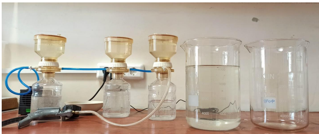
Рисунок 3.6 – Процесс фильтрования снеговой воды
