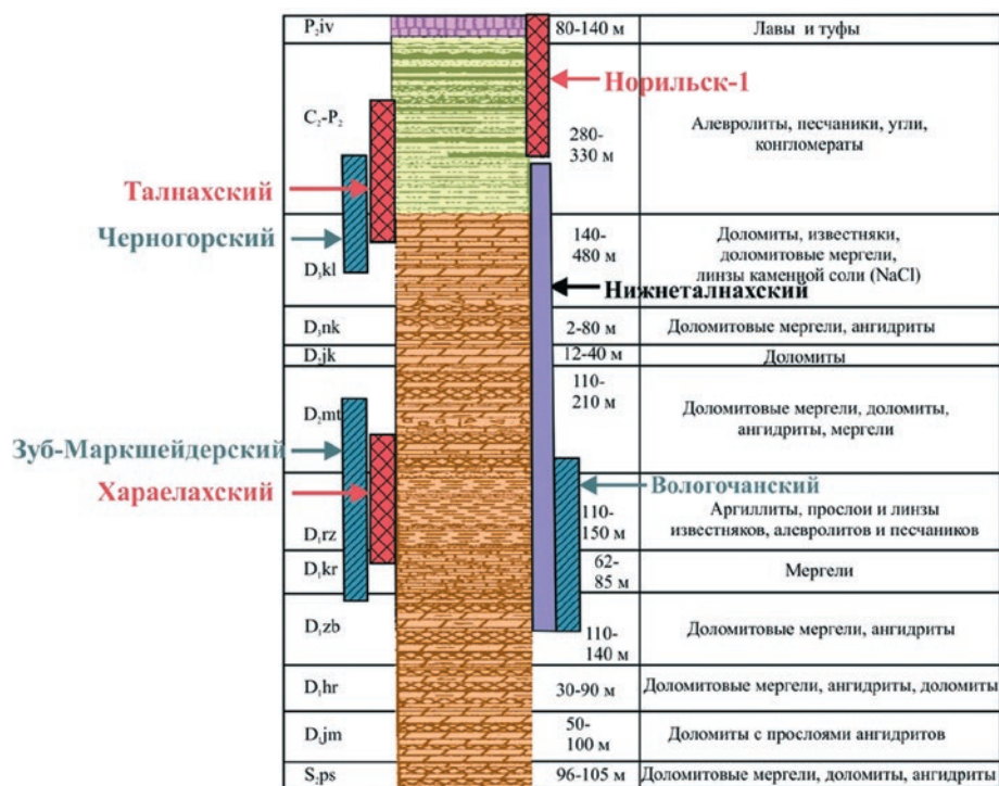
Рис. 2. Стратиграфический разрез, показывающий расположение промышленно-рудноносных (Хараелахского, Талнахского и Норильск-1), рудоносных (Черногорского, Зуб-Маркшейдерского и Вологодчанского) интрузивов и слаборудоносного Нижнеталнахского интрузива [по данным Дюжикова и др. [1992] и Czamanske et al. (1995)].
