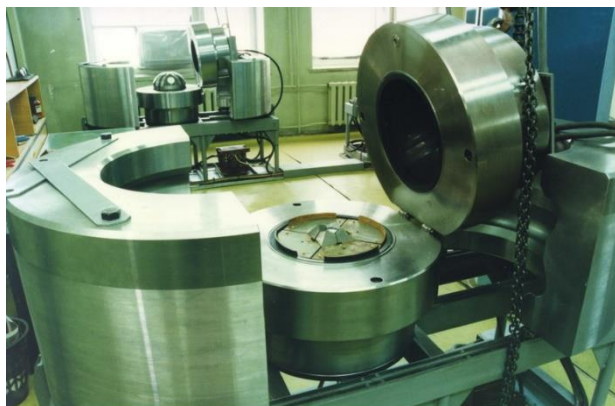
Рис. 1. Многопуансонный аппарат высокого давления “БАРС”.
