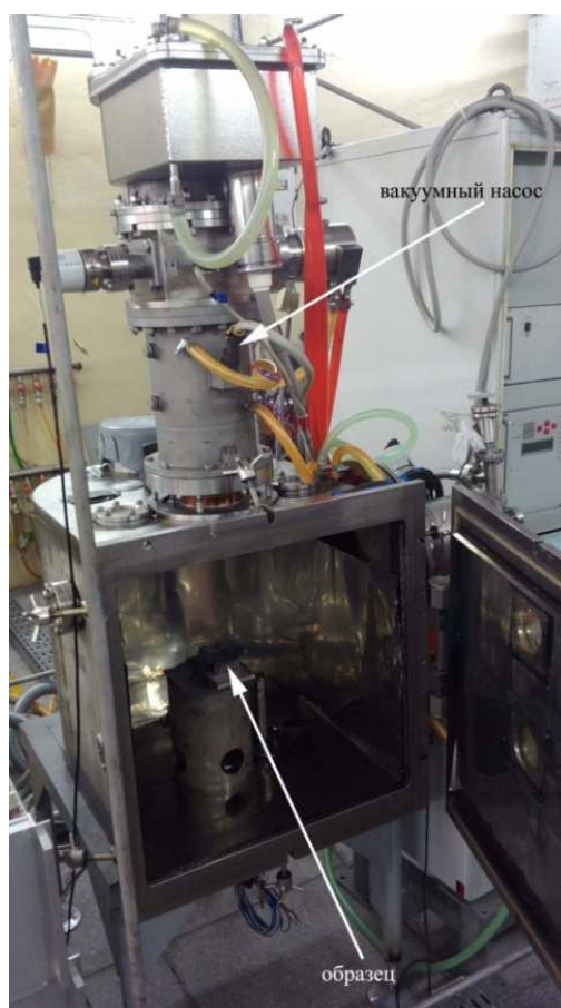
Рис. 1.2. Используемая установка электронной сварки ИЯФ СО РАН.
