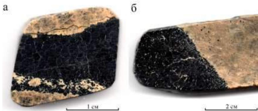
Рис. 2.28. Фотографии полированных образцов массивных скоплений хромшпинелида. На изображении «а» виден резкий контакт в верхней части и морфологически сложный переход к дуниту в нижней; на изображении «б» виден резкий контакт, наблюдается увеличение зернистости хромшпинелида по направлению к центральной части прожилка
