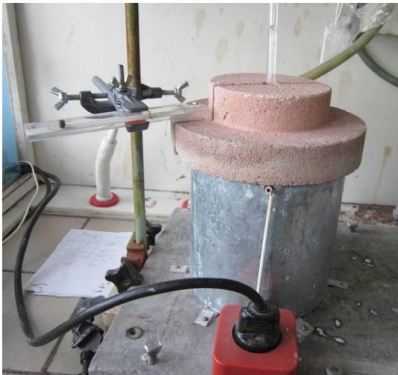
**Рисунок 3.6.** Установка для выращивания кристаллов  $\text{K}_2\text{Va}(\text{NO}_3)_4$  из раствора-расплава.
