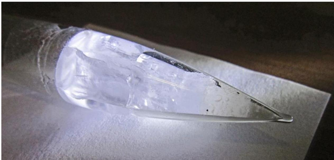
**Рисунок 3.13.** Монокристалл  $\text{Rb}_2\text{Na}(\text{NO}_3)_3$
