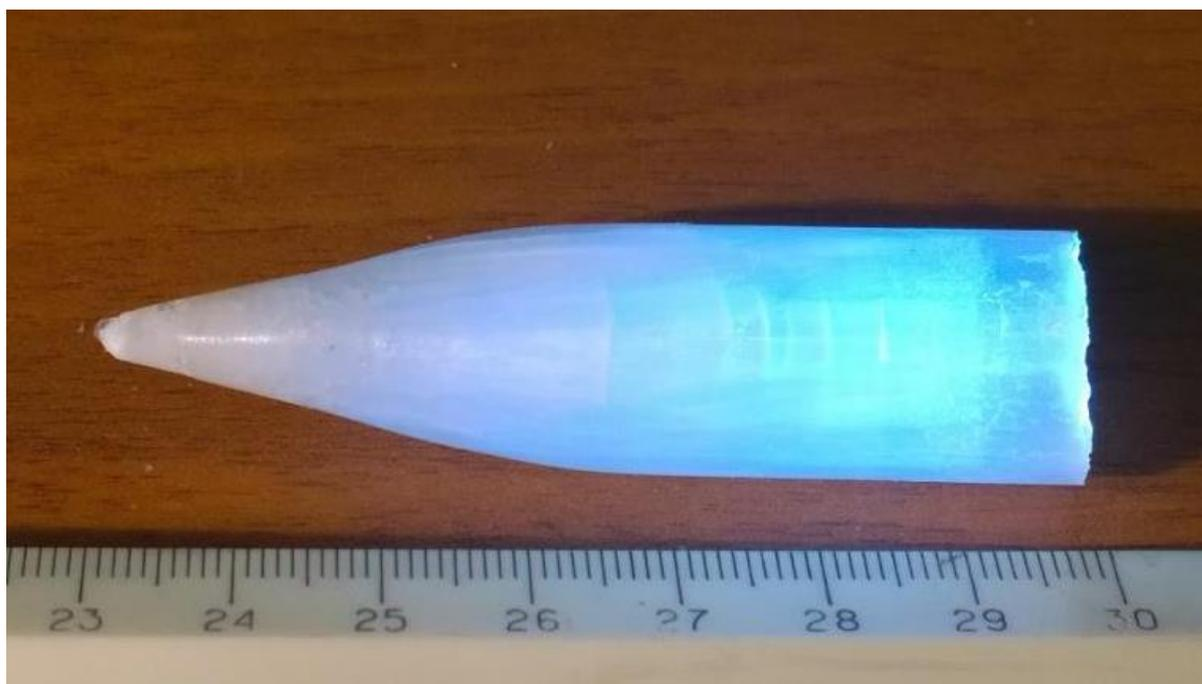
**Рисунок 3.12.** Смесь кристаллов  $\text{NaNO}_3$  и  $\text{Rb}_2\text{Na}(\text{NO}_3)_3$  полученная при 68%  $\text{RbNO}_3$  и 32%  $\text{NaNO}_3$
