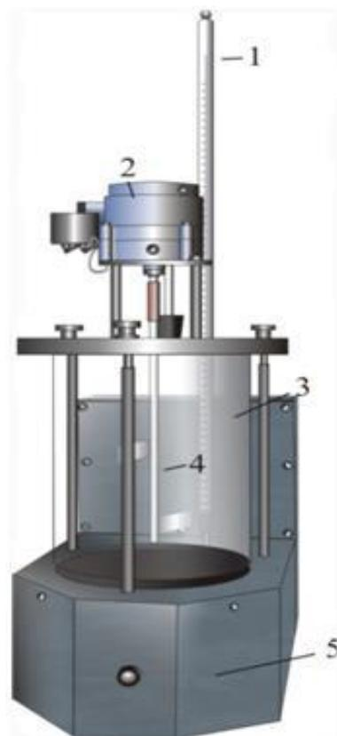
**Рисунок 2.1.** Схема установки для выращивания кристаллов из водных растворов (1 – термометр, 2 – вращающий механизм, 3 – кристаллизатор, 4 – вращающаяся подставка, 5 – подставка кристаллизатора).
