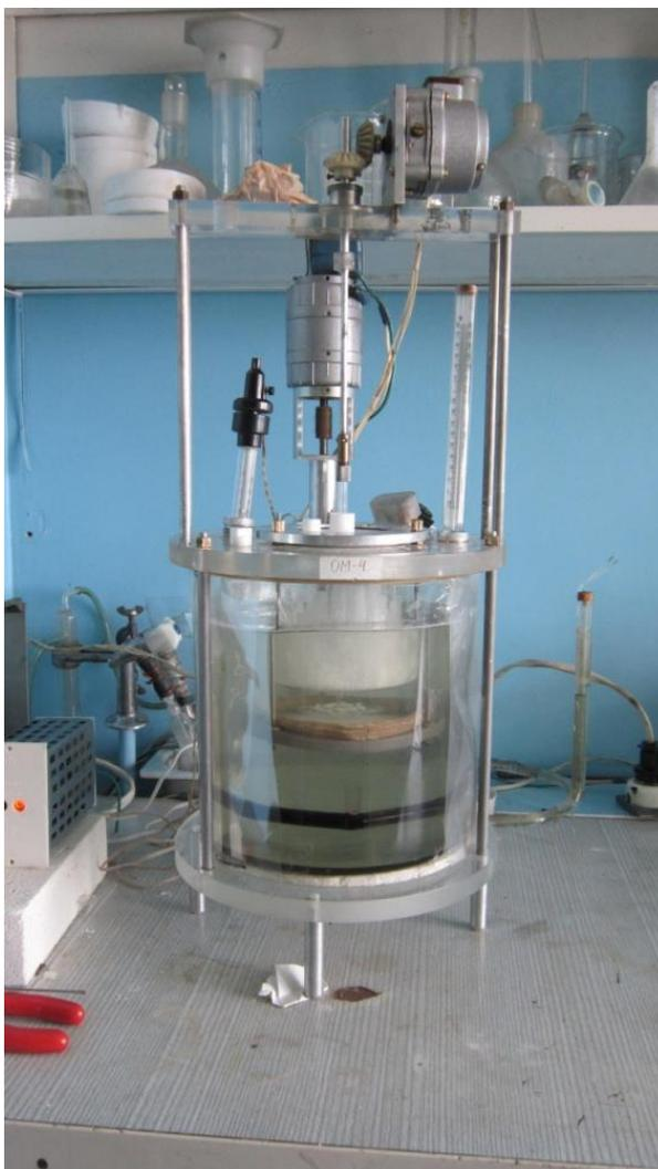
**Рисунок 3.2.** Установка для выращивания кристаллов  $K_2Ba(NO_3)_4$  из водных растворов.
