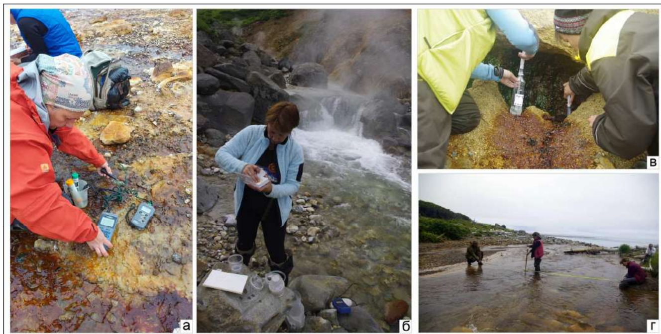
Рисунок 2.6. – Виды полевых работ: определение физико-химических показателей воды (а); фильтрование водной пробы (б); отбор водных проб с фильтрованием через шприц (в); измерение скорости водного потока (г). Автор фото – Т. Котенко
