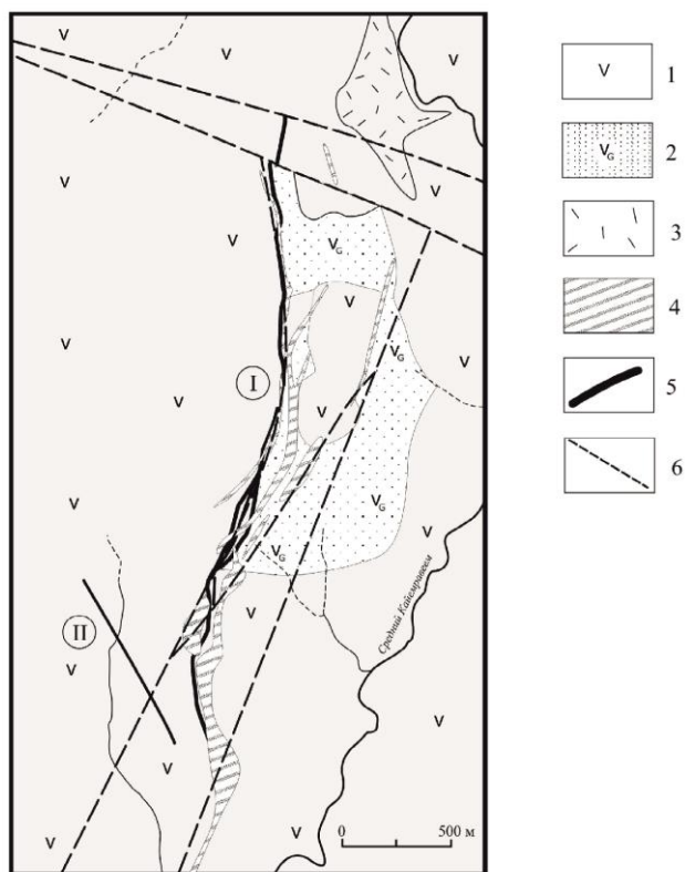
Рис. 55. Схематическая геологическая карта месторождения Купол [Глухов, 2008]: 1, 2 – лавы (1) и грубообломочные туфы (2) андезитов и андезибазальтов вилковской толщи; 3 – игнимбриты и туфы риолитов еропольской толщи; 4 – дайки позднемеловых риолитов; 5 – рудные тела; 6 – разломы. Римские цифры: I – Главная рудная зона, II – Вторая рудная зона
