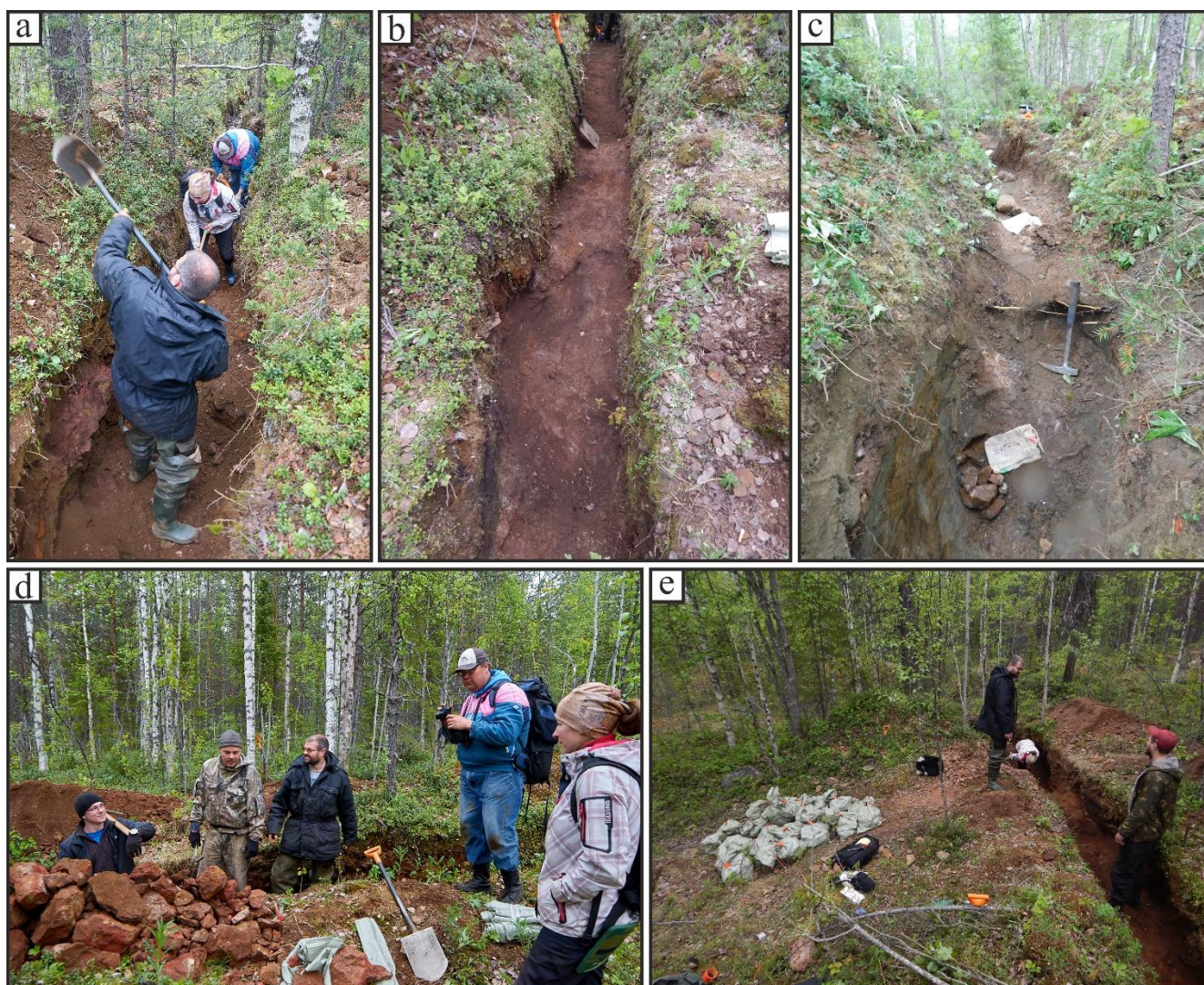
Рисунок 3. Внешний облик разведочных канав, из которых отбирались образцы карбонатитов (на примере канавы 15K05а). (а) Процесс подновления канав и (б) полученный результат. (с) Фотодокументация пробоотбора. (d) Отбор полутехнологической пробы анкилитовых карбонатитов (красные породы на переднем плане) и (е) подготовленная проба.
