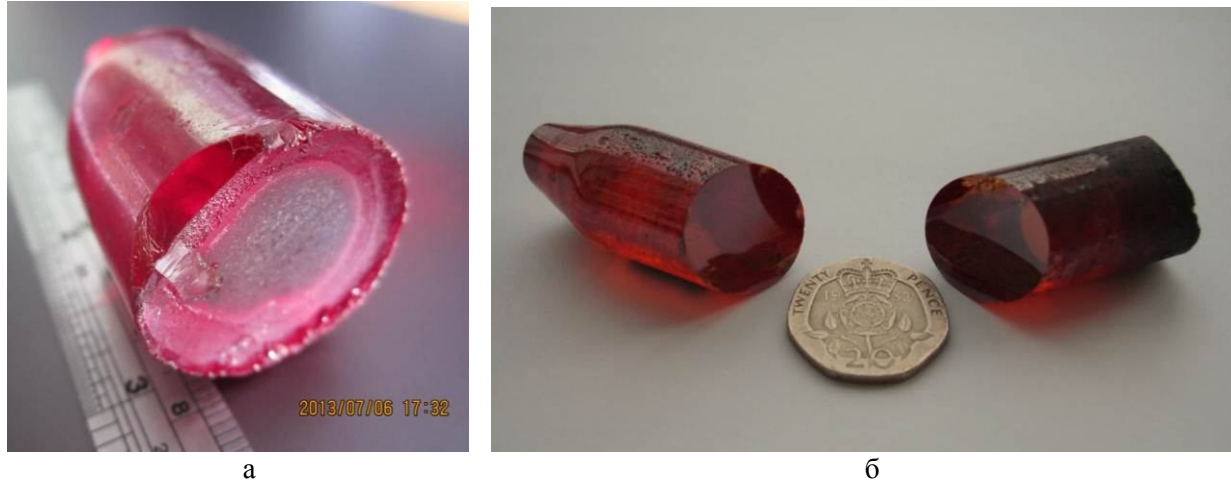
Рис.1. Внешний вид кристаллов легированных серой: GaSe:S(0,15 масс.%) (а) и GaSe:S(11 масс.%) (б).
