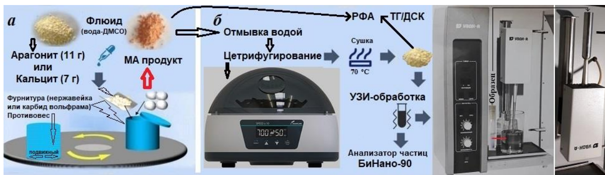
Рис. 2. Схема опытов по МА (а) и подготовки образцов для измерений (б)
