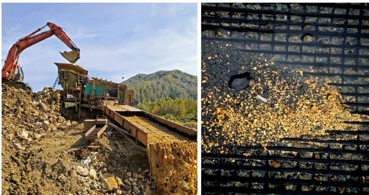
Рис. 3. Промывка золотоносных пород на притоках р. Бердь с помощью промприбора. Тяжёлые частицы золота задерживаются на установленных на наклонной поверхности резиновых ковриках, а все легкие песчинки и глина смываются потоком воды
