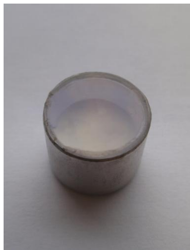
Рисунок 3.11. Кристалл \text{Sr}_{0,97}\text{Eu}_{0,03}\text{I}_2 в алюминиевом контейнере. Размер: \varnothing 19 \times 40 мм.
