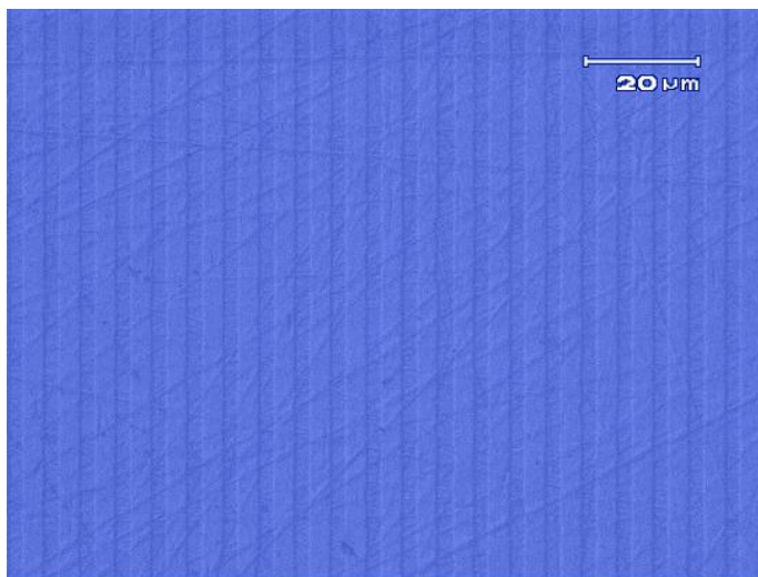
Рисунок 1.22 Фотография среза кристалла \text{BaMgF}_4 , периодически поляризованного с образованием доменов шириной 6.6 мкм.
