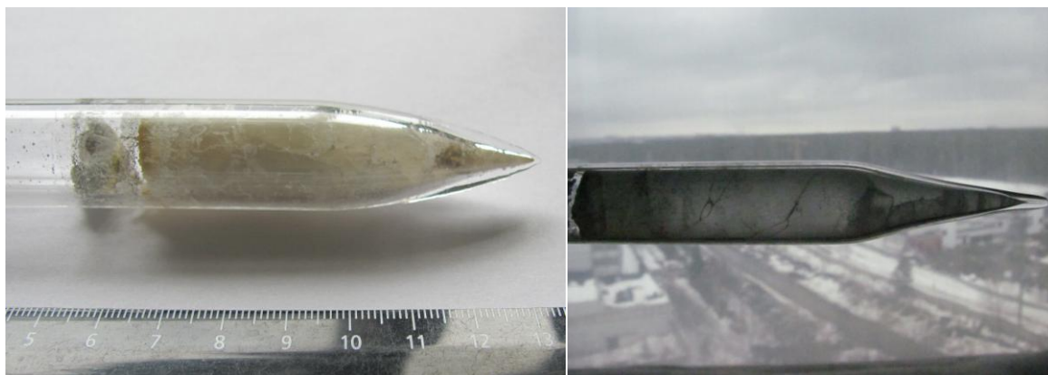
Рисунок 3.19. Кристаллы, выращенные при соотношении SrBr_2: PbBr_2 = 1:1 (слева) и 1:2 (справа).
