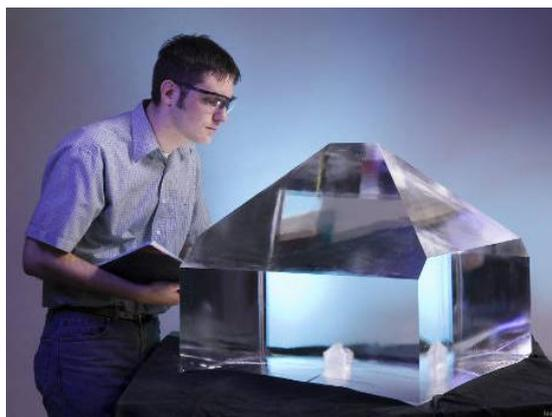
Рис. 1.2\_6. Фотография кристалла KDP (~380 кг), выращенного скоростным методом в течение двух месяцев, Ливерморская национальная лаборатория им. Э.Лоуренса, США
