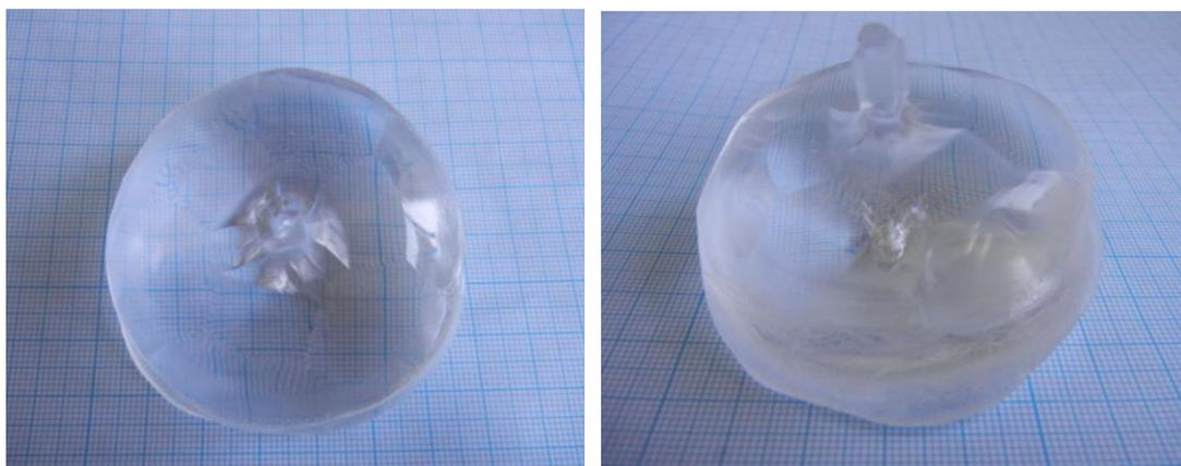
Рис. 3.1\_5. Фотографии кристалла, выращенного в системе VI.  $BaB_2O_4-NaBaVO_3-Ba_2Na_3[B_3O_6]_2F$ .
