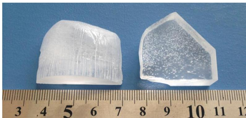
Рис. 3.1\_2. Фотографии фрагмента кристалла, выращенного в системе  $\text{BaB}_2\text{O}_4\text{-(NaBO}_2)_2$  и изготовленной из него пластины.
