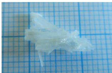
Рис. 4.1\_2. Фотография поликристаллического сростка  $\text{Ba}_7(\text{VO}_3)_{4-y}\text{F}_{2+3y}$ , выращенного на платиновую петлю из состава 25 мол. %  $\text{BaB}_2\text{O}_4$ , 35 мол. %  $\text{BaF}_2$ , 40 мол. %  $\text{BaO}$  (Bekker, Rashchenko, Vakakin et al., 2012b).
